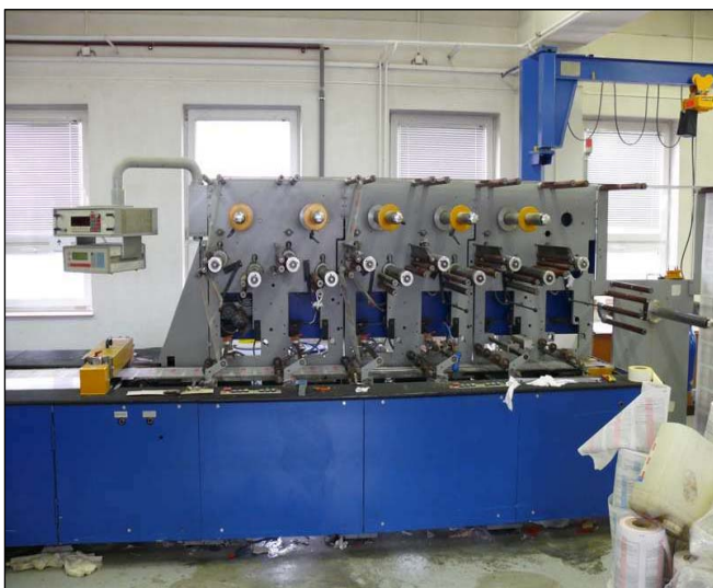
Různé stroje, které provádějí snášení archů, personifikaci dat pomocí digitálních technologií jsou důležitým nástrojem pro identifikování různých cenin, např. akcí na jméno. Snášecí stroje pak dokážou vytvořit vícevrstvé tiskoviny např. s průpísem.
